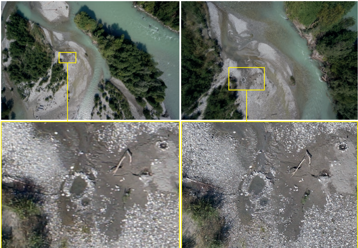
Abb. 6: Drohnenaufnahmen desselben Flussbereichs (Abschnitt Bonaduz) aus 60 m (linkes Bildpaar) und aus 30 m Höhe (rechtes Bildpaar) mit ihren jeweiligen Auflösungsgrenzen
